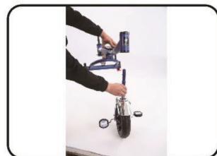
Zamontuj przedni widelec do ramy
