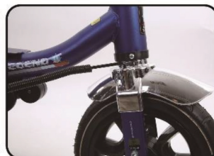
Przymocuj pręt sterujący do widełca
