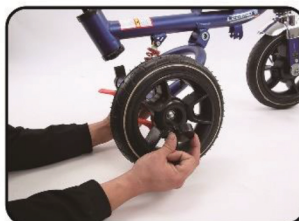
Założ plastikową osłonę osi koła
